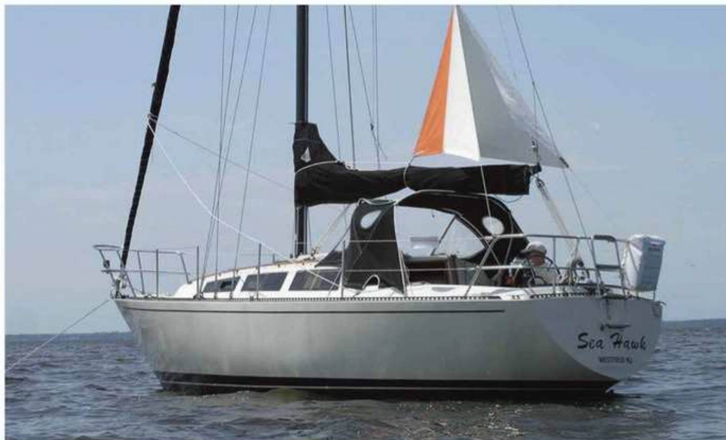
La vela anti-brandeggio a V è costituita da due semivelette simmetriche, una delle quali è sempre in azione per diminuire il brandeggio dell'imbarcazione.
